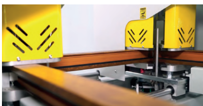
Doble soldadura a la vez automática
