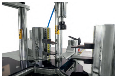
Sistema de refrigeración con taladrina
